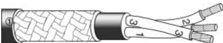
Verzinkter Stahl oder verzinnte Kupferleiter mit geflochtenem Schirm
