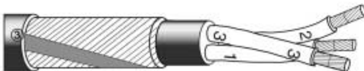
Konzentrische Lage aus Kupferdraht mit einer offenen Spirale aus Kupferband.
