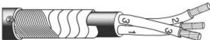
Lage Kupferband mit konzentrischer Lage aus Kupferdraht.
